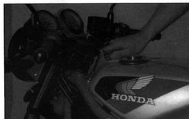
Bild 4 Vordere Halteschraube nur lockern
