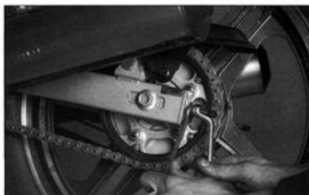
Bild 29 Durchhang der Antriebskette korrigieren
