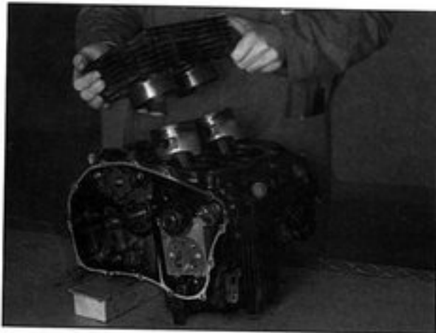
Bild 83 Zylinder vorsichtig abziehen
