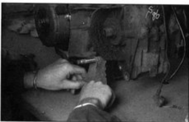
Bild 90 Welle eventuell mit Schmirgelleinen abziehen
