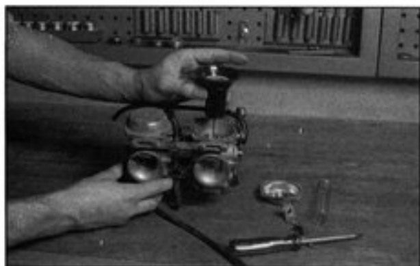
Bild 114 ▶ Nadelaufhängung, Feder und Düsennadel ausbauen
