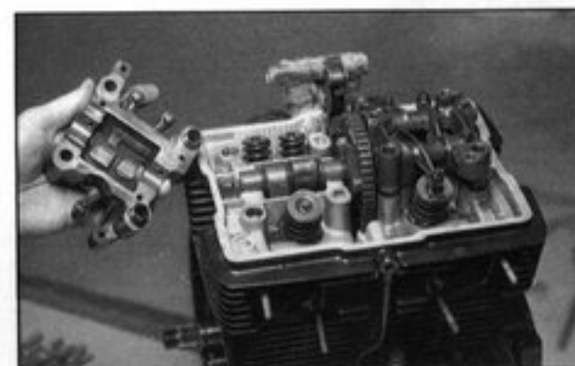
◀ Bild 77 Zylinderkopfschrauben in angegebener Reihenfolge lösen
