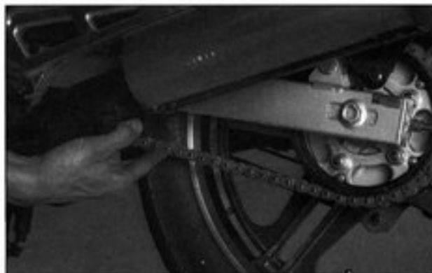
Bild 28 Durchhang der Antriebskette prüfen
