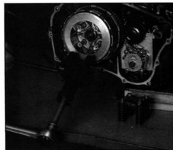
Bild 259 Neue Kupplungsgegenmutter leicht anziehen
