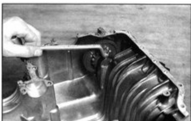
◀ Bild 105 Pleuel beim Ausbau markieren
