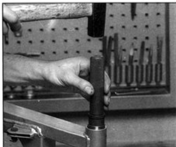
Bild 185 Kugellager der Schwinge eintreiben
