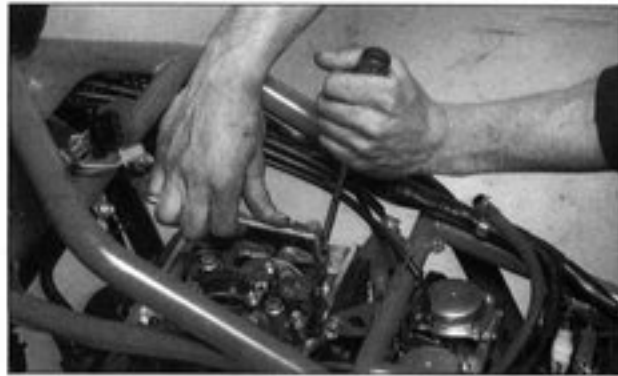
Bild 20 Nachjustieren des Ventilspiels
