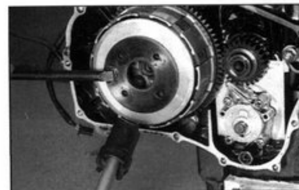
Bild 87 Kupplungs-nabenhalter und Spezialschlüssel ansetzen
