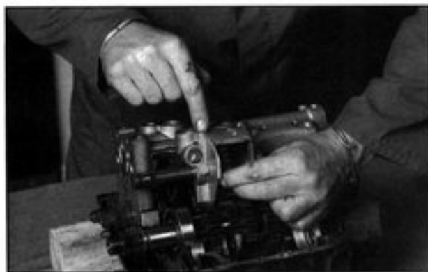
Bild 245 Welle des Ausgleichsgewichts einschieben
