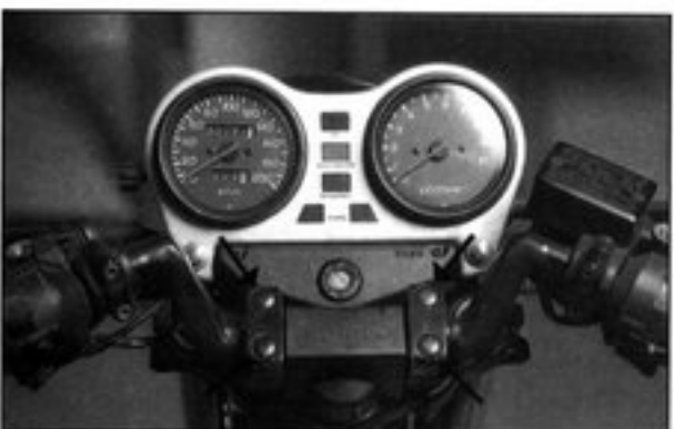
Bild 134 Schrauben der Klemmfäuste entfernen
