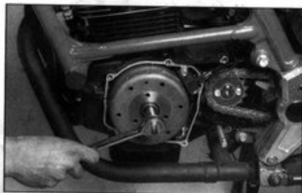
Bild 17 Schwingscheibe gegen den Uhrzeigersinn drehen
