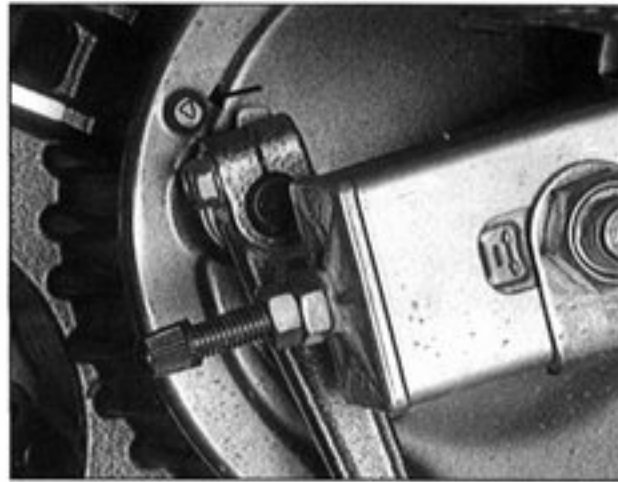
Bild 35 Bremsbelagstärke von aussen kontrollieren
