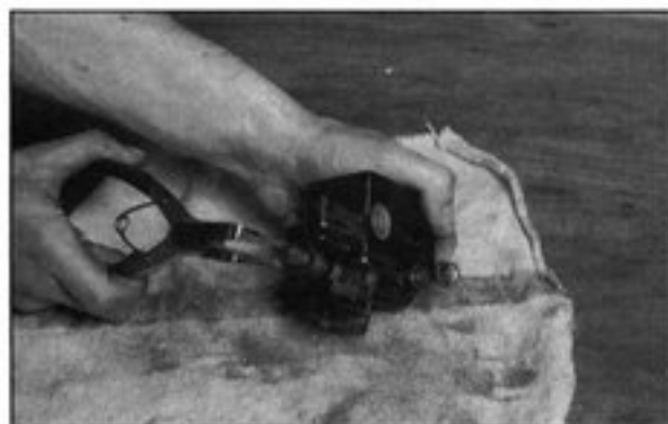
Bild 213 Sicherungsring des Kolbens einsetzen
