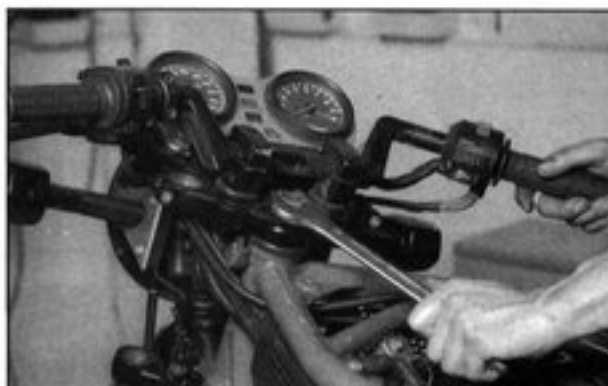
Bild 136 Mutter der Lenkachse lösen
