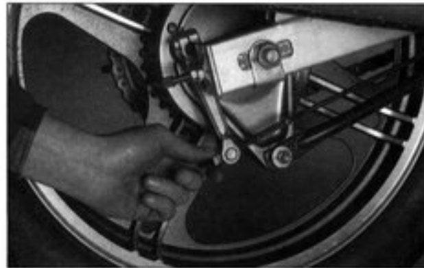
Bild 37 Leerweg der Fussbremse einstellen
