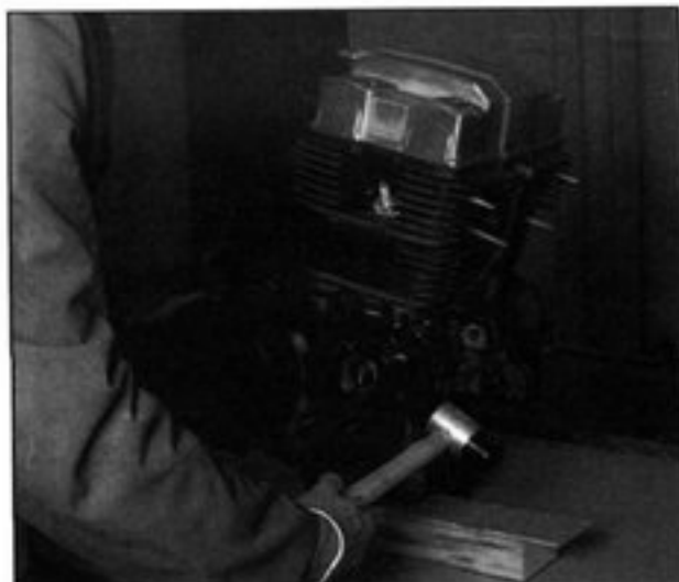
Bild 85 Gehäusedeckel mit Kunststoffhammer lösen
