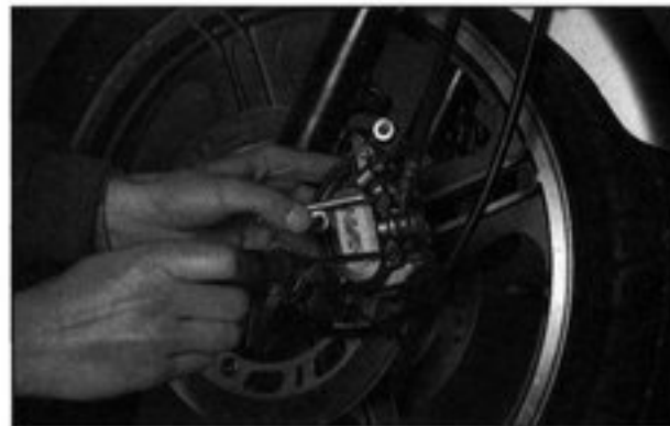
Bild 123 Beide Kopfschrauben herausdrehen
