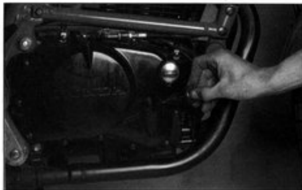
Bild 22 Ölstand mit Tauchstab messen
