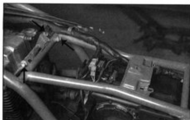
Bild 279 Haltetasche am Zylinderkopf anschrauben
