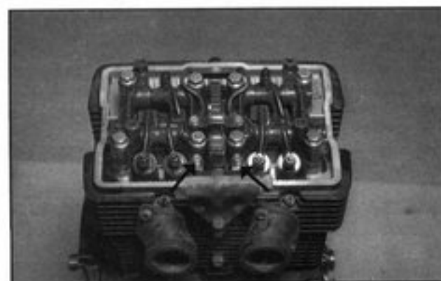
◀ Bild 75 Drei Schrauben der Ölleitungen lösen
