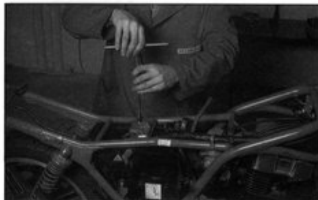
Bild 66 Schrauben am Luftfilterkasten lösen
