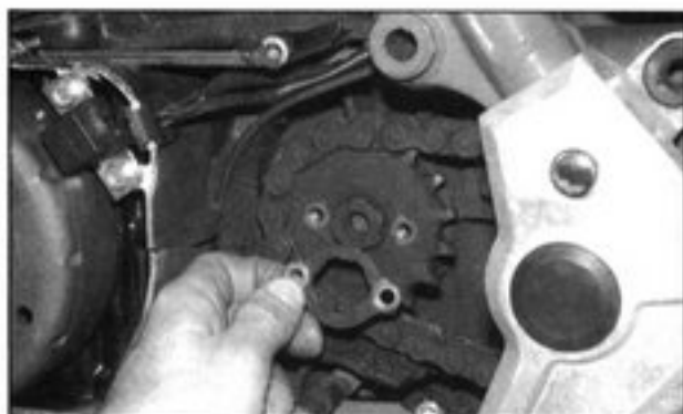
Bild 53 ▶ Antriebsritzel von der Welle ziehen
