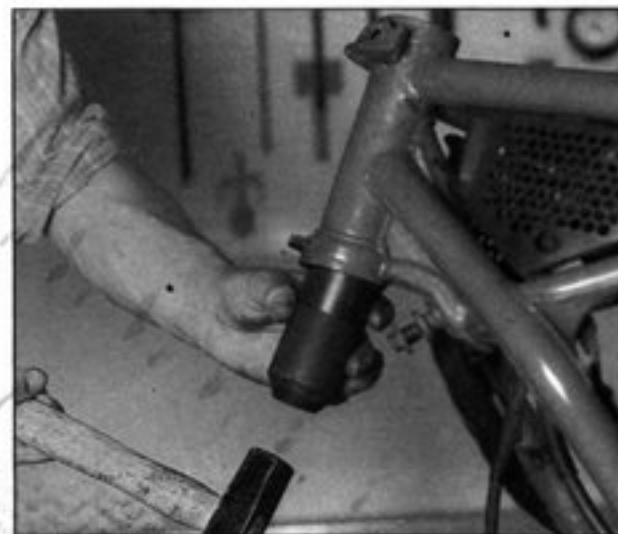
Bild 197 Kugellaufringe in den Lenkkopf eintreiben
