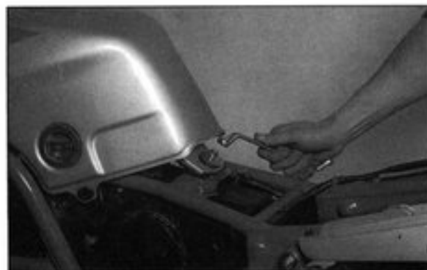
Bild 3 Hintere Halteschraube entfernen
