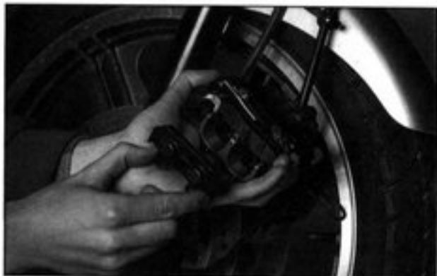
Bild 217 Bremsklotz mit Noppen zeigt nach innen
