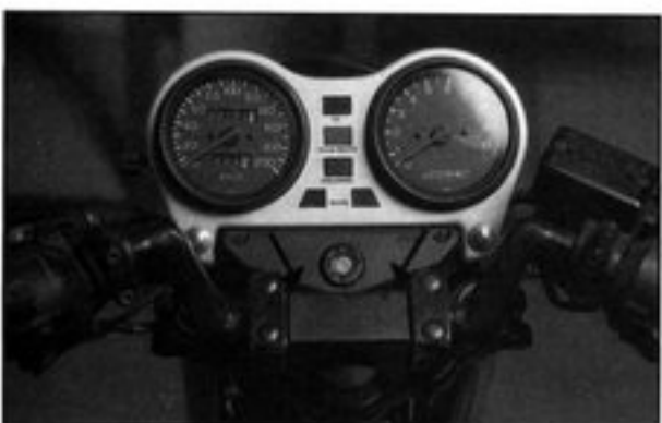
Bild 132 Beide Deckelschrauben lösen
