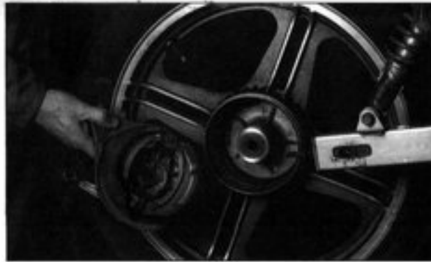
Bild 194 Bremsse komplett in Radnabe setzen
