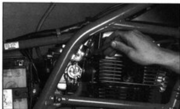
Bild 6 Untere Einstellmutter lösen
