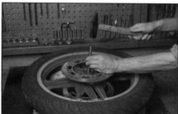
Bild 128 Lager mit leichten Schlägen austreiben
