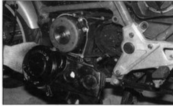
◄ Bild 285 Ansatzstück der Öleitungen befestigen
