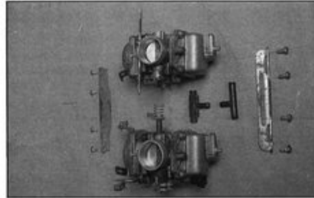
◀ Bild 223 Schwimmerkammern anschrauben
