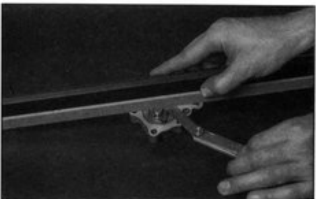
Bild 153 Spiel am Pumpengehäuse messen
