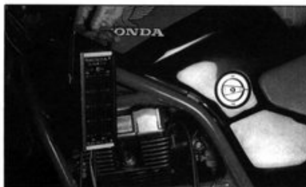
Bild 26 Synchronisieren der Vergaser
