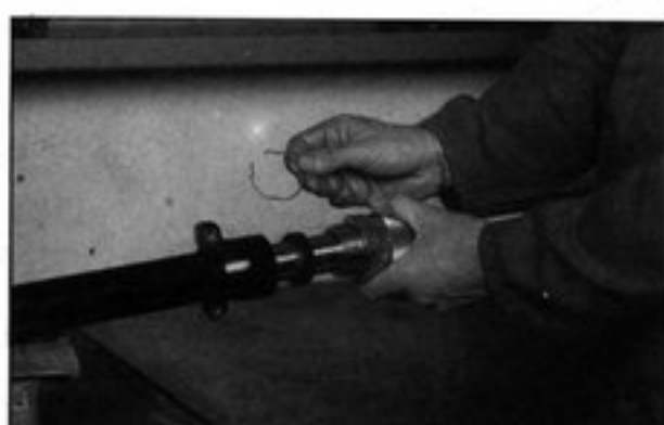
Bild 202 Führungsbuchse und Verstärkerring eintreiben
