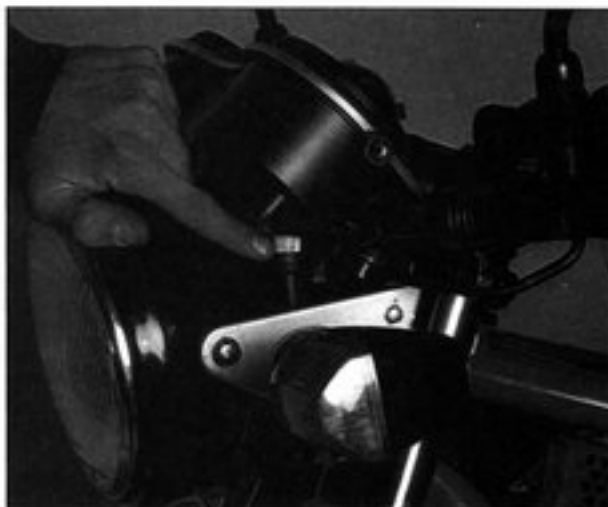
Bild 135 Tachowelle nach Lösen der Rändelmutter herausziehen
