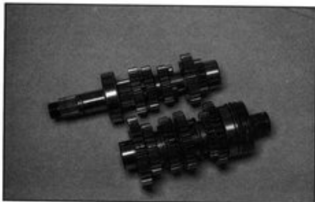
Bild 232 ▶ Getriebehauptwelle einsetzen, Ölregelblende einstecken
