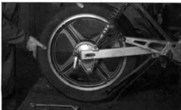
◀ Bild 141 Bremsankerschraube lösen (Pfeil)
