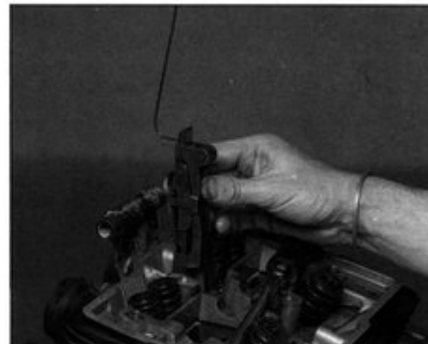
Bild 270 Spanner in Schacht schieben
