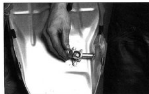
Bild 5 Filterbecher vorsichtig einbauen
