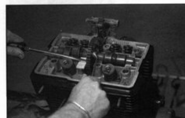
◀ Bild 79 Kipphebellagerböcke zerlegen
